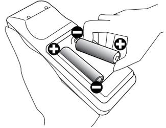
**△경고** ▶ 배터리는 언제나 주의하여 취급하고 지시된 대로만 사용합니다. 배터리를 올바르게 사용하지 않으면 배터리의 폭발, 균열 또는 누액이 발생하여 화재, 부상 또는 주변 환경의 오염이 발생할 수도 있습니다.
