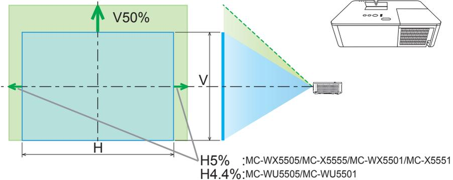
**△주의** ▶ 렌즈가 충격을 받으면 오작동을 일으킬 수도 있으므로 렌즈 조절기를 부드럽게 조작하십시오. 조절 한도 부근에서는 조절기를 돌리는 데 힘이 더 들 수도 있습니다. 너무 무리한 힘을 가하지 않도록 주의하십시오. 렌즈 조정장치를 과도하게 돌리면 조정장치 내부의 클러치 메커니즘에 의해 조정장치가 공회전합니다. 딸깍 소리가 나지만 이는 고장이 아닙니다. 렌즈 조정장치가 공회전하면 렌즈 시프트를 더 수행할 수 없습니다. 렌즈 조정장치를 반대 방향으로 돌려 렌즈 시프트를 조정합니다. 렌즈 조정장치를 너무 빨리 돌리면 클러치 메커니즘에 의해 딸깍 소리가 날 수 있습니다. 그런 경우에는 천천히 돌려서 렌즈 시프트를 조정하십시오.
