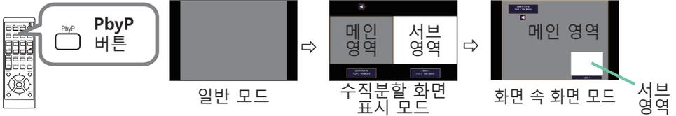
리모컨의 **PbyP** 버튼을 누릅니다 . 수직분할 화면 표시 모드를 활성화합니다 . 그런 다음 **PbyP** 버튼을 다시 누릅니다 . 프로젝터가 화면 속 화면 모드로 전환됩니다 . **PbyP** 버튼을 누르기 전에 표시되었던 화면이 메인 영역으로 표시됩니다 . 대부분의 조작은 메인 영역에 대해서만 유효합니다 . 메인 영역에 대해서 화상 입력 신호와 짝을 이루는 오디오 입력 신호만을 출력합니다 . 화면 속 화면 모드를 종료하려면 **PbyP** 버튼을 다시 누릅니다 .
