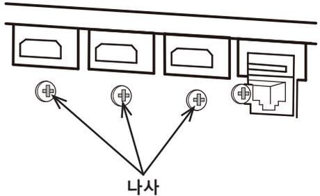
그림과 같이 제공된 HDMI 케이블 홀더와 케이블 타이를 사용해 HDMI 케이블이 빠지지 않도록 고정하는 것이 좋습니다. 2.0 x 4.0mm 이하 크기의 케이블 타이를 사용하십시오.
